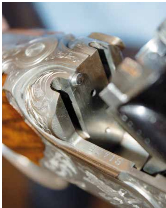
Le mortise della chiusura e la faccia di bascula con i fori dei percussori e il nottolino per la rimessa al centro della chiave a fucile scomposto. Sostanzioso lo spessore della parete che funge da tavola
