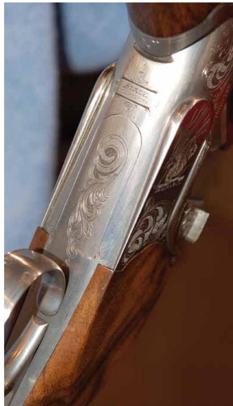
Il dorso è marcatamente arrotondato, ma insieme a tale prerogativa rimangono le due cordonature rastremate e ben lucidate a mano: un segno distintivo che a noi piace molto
