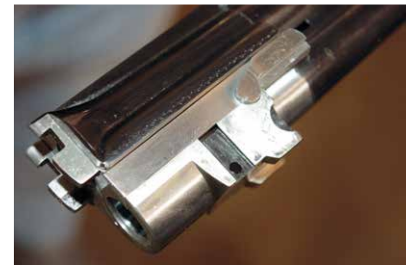
Manca qui l'impianto di estrazione automatica che farà parte della dotazione del fucile. Sopra all'orecchione si nota il risalto dell'estrattore: anche questo particolare è evidentemente da rifinire...appena terminata la Fiera
