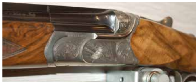
Il particolare mostra la linea dei seni e il rinforzo modellato che discende dalla scalfatura della testa di bascula, l'arco a tutto sesto del leggero ispessimento del fianco e la strombatura delle canne in culatta: tutto molto elegante
