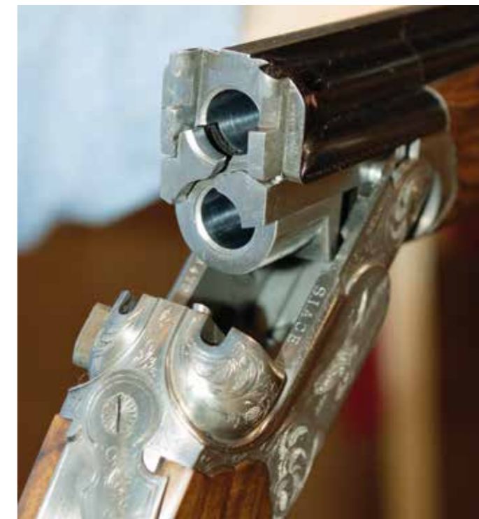
I seni di bascula sono messi in evidenza dai filetti lucidati e recano le mortise per i prolungamenti della doppia chiusura, la chiave ha ancora nell'occhio la bella vite a spacco fine e gli estrattori sono ben dimensionati
