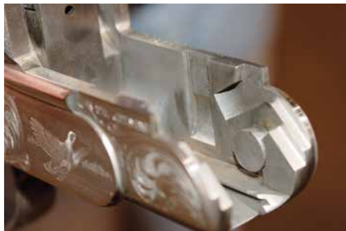
Uno dei due semiperni con il rinforzo a trapezio ricavato dal pieno; sopra la camme per l'estrazione primaria e la fresatura verticale per l'estrattore automatico. Sul fondo la sede della slitta di armamento delle batterie
